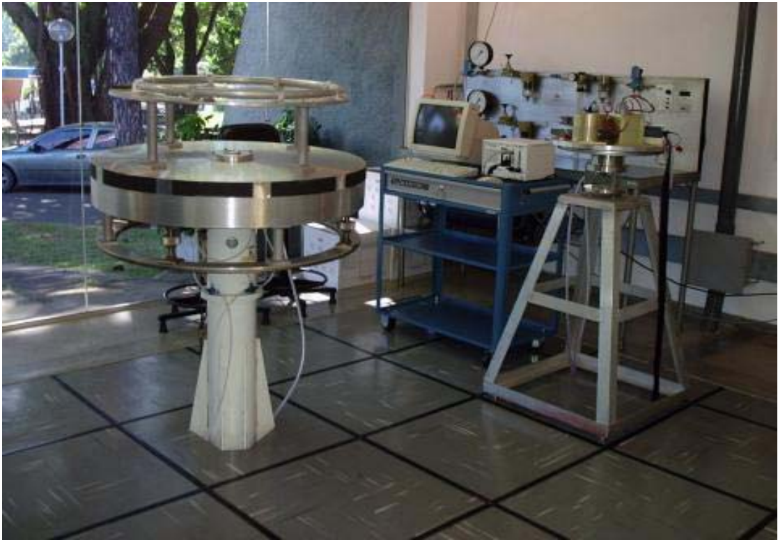
Figura 1 – As duas plataformas do LabSim: à esquerda rotação em 3 e à direita em 1 eixo
